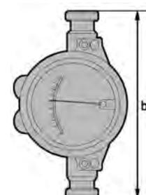
① Нержавеющая сталь 1.4435 - протестировано EHEDG – контактирующая с продуктом поверхность Ra ≤ 0,8 / 0,6 мкм
