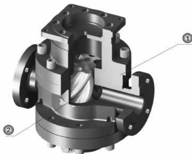
Рисунок 2. Конструкция первичного преобразователя
