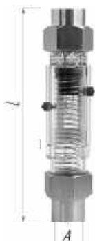
Рисунок 2. Габаритные и присоединительные размеры ротаметров ЭМИС-МЕТА 210Г
