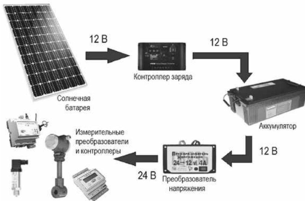
Рисунок 2. Принцип работы узла с солнечной панелью
