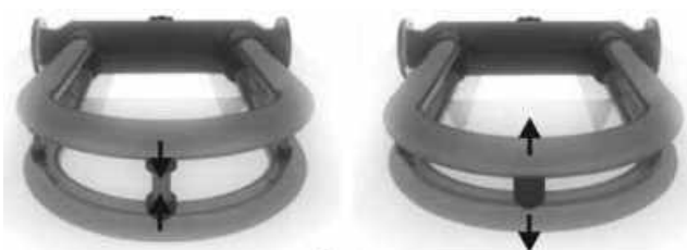
Рисунок 2. Направление сил, действующих на расходомерные трубки в разные моменты времени без потока
