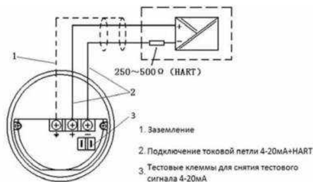
Рисунок 4 Схема подключения датчика
