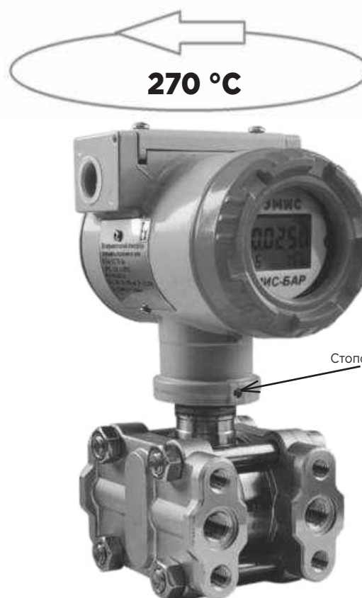
Рисунок 7. Угол поворота электронного блока
