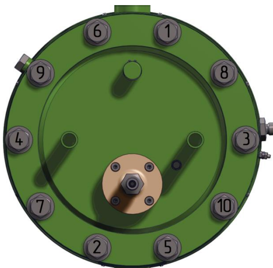
Рисунок 2.5 – Последовательность затяжки болтов фланца
