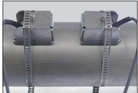
Датчики в монтажном башмаке, крепление затяжным ремнем
